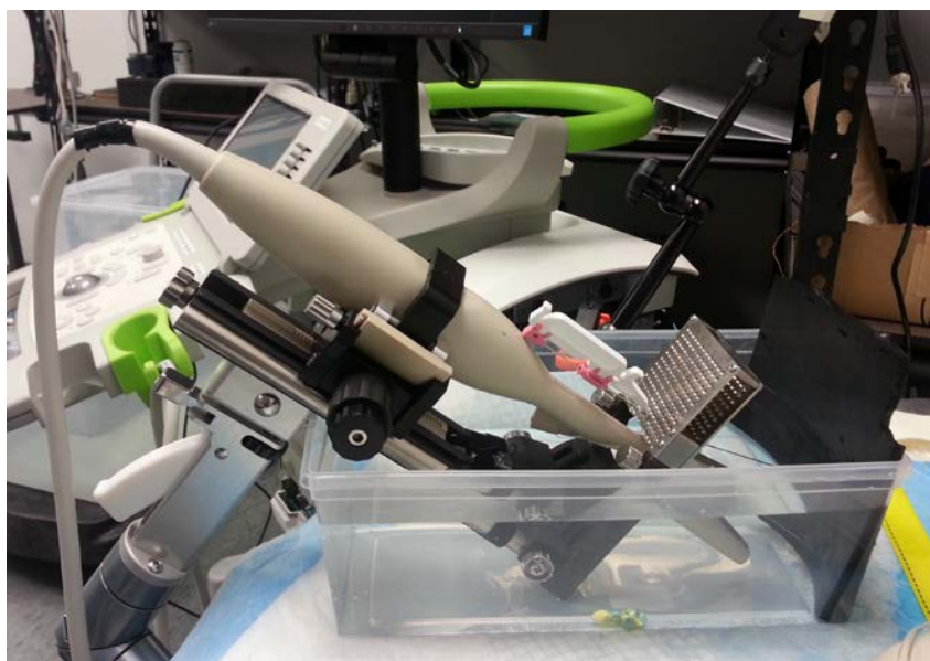
Figur 41: Probe og transperineal trinnanordning i vannbad
