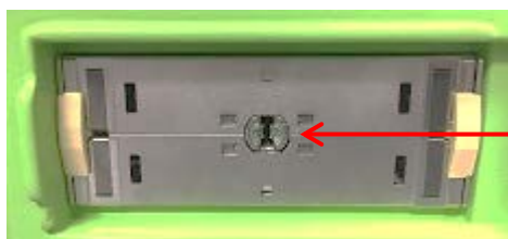
Figur 27: Låsehakk på probetilkoblingssporet
