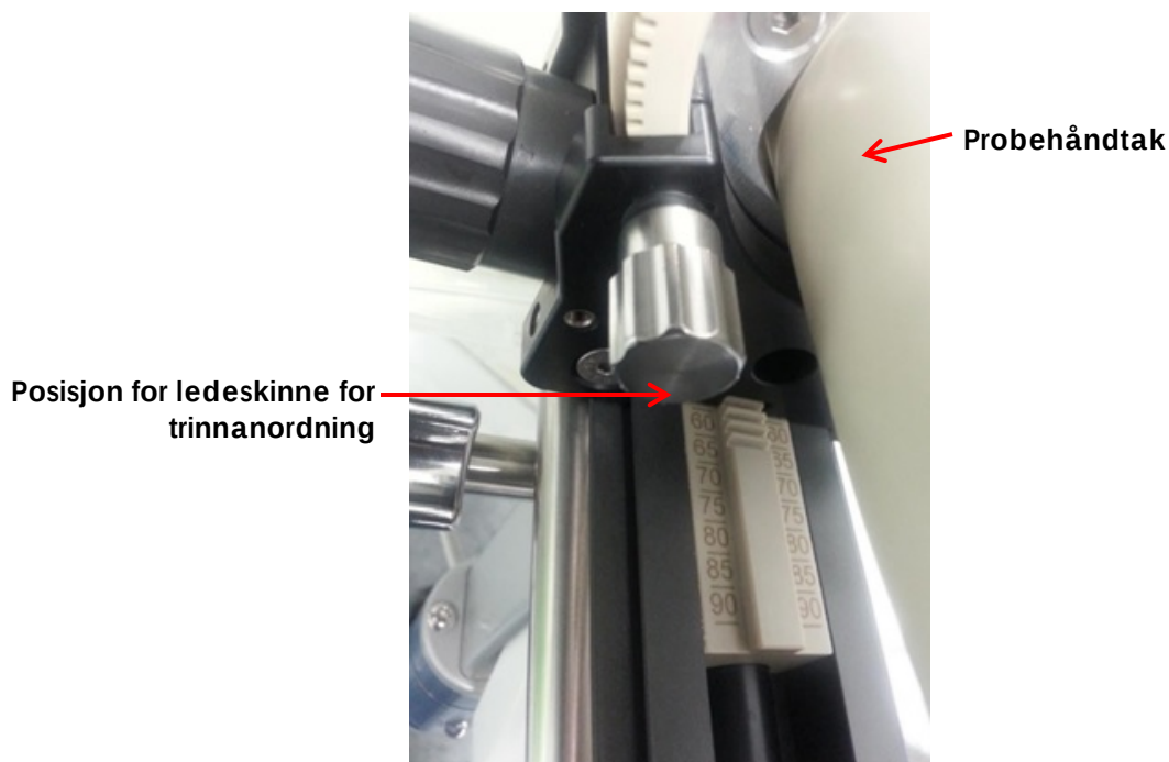
Figur 40: Posisjon for ledeskinne for trinnanordning
