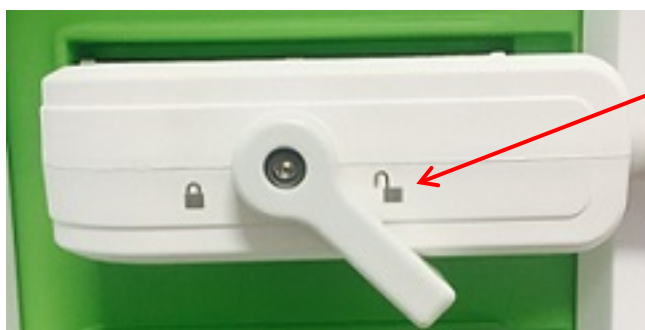
Figur 29: Låseknot for probetilkobling i ulåst posisjon
