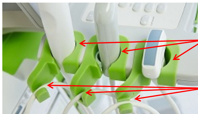
Figur 36: Probe-/gelholdere og kabelførere
